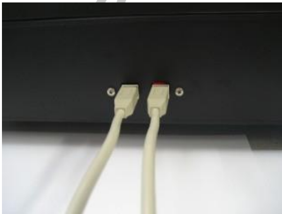
AFT 의 뒤쪽 데이터와 모터 제어 케이블
