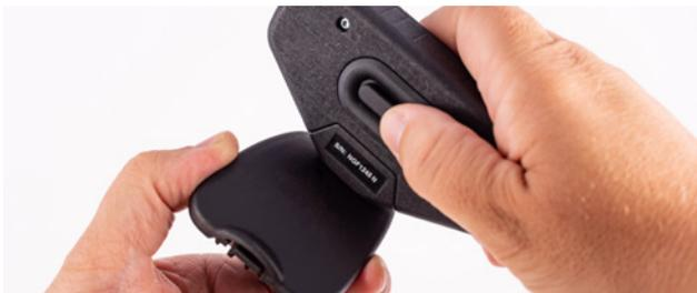
Das Novo-Gloss Flex 60 wurde speziell für die Messung von Oberflächen mit geringem Glanz entwickelt. Es verfügt über eine zusätzliche Messskala mit einer 10-mal höheren Auflösung als herkömmliche Glanzmessgeräte. Diese erhöhte Auflösung ermöglicht eine weitaus bessere Kontrolle der Oberflächenbeschaffenheit.
