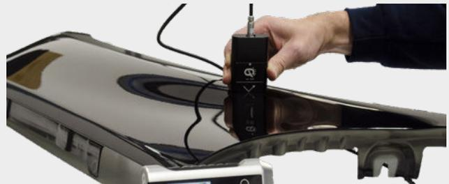
Der Rhopoint IQ Flex 20 quantifiziert Oberflächenqualitätsprobleme wie Orangenhaut und Trübungen, die für ein herkömmliches Glanzmessgerät unsichtbar sind. Er erstellt ein Profil der Lichtreflexion auf einer Oberfläche.
